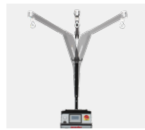
ASTA GIREVOLE Con scorrimento supporto pinza
